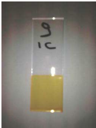
Figure III.10 : Photo d'un seul dépôt effectué à la vitesse de tirage 4 cm/min puis séché pendant 10 mn à la température 100°C environ (Echantillon 1).
