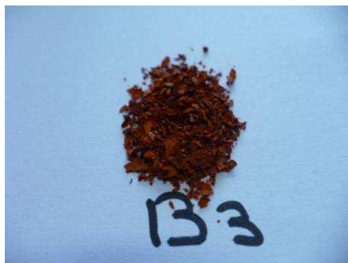
Figure II.19 : Image photo de l'échantillon B3 de rapport massique \text{FeAc}_2/\text{PVP}=0,87 , suite à un traitement thermique à 550^\circ\text{C} pendant 4h.
