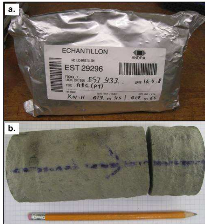
Figure 4-14 : Les échantillons et le transport : (a) sac en aluminium de protection et étiquette d'identification et (b) illustration du phénomène de disquage. La flèche dessinée sur l'échantillon est perpendiculaire à la stratification et son sens indique la partie supérieure de la formation.
