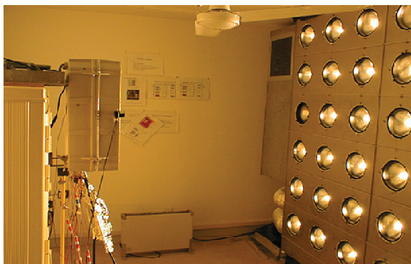
Figure II.10b. Salle d'essais d'armoire de télécommunication.
