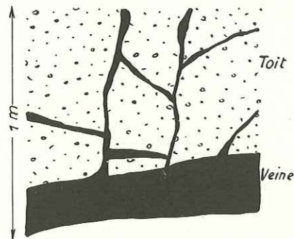
FIG. 26. — Filonnets d'anhracite injectés dans un toit de grès fissuré.
