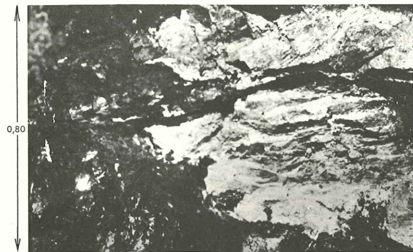
FIG. 40. — Inclusions de microdiorite dans le charbon de la couche 7-7 bis de la Benoite.
