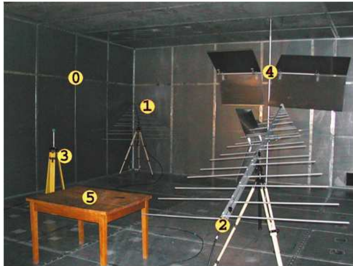
FIGURE 4.1 – Vue intérieure de la CRBM du LASMEA ( 6,7 \times 8,4 \times 3,5 \text{ m}^3 ). Caractéristiques : (0) parois, antennes (1) d'émission et (2) de réception, (3) sonde de champs, (4) brasseur mécanique, (5) VU.
