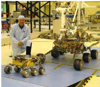
(c) Robots Sojourner (10 kg) et Opportunity/Spirit (175 kg), posés sur Mars les 04/07/1997 et 24/01/2004
