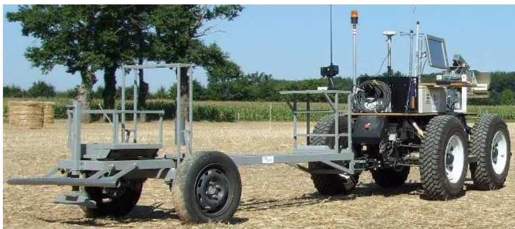
FIGURE 2 – RMPA expérimental : robot mobile tout terrain à deux trains directeurs associé à une remorque passive à attache déportée à un train roulant.
