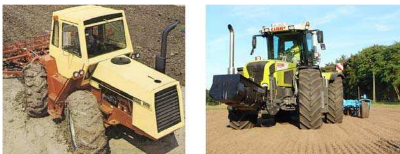
FIGURE 1.15 – Deux trains directeurs pour compenser les glissements ou avancer en crabe
