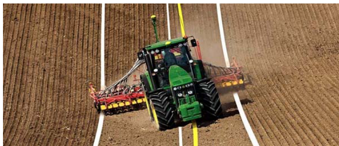
FIGURE 1.17 – Le tracteur décale sa trajectoire pour positionner correctement l'outil (src. John-Deere)
