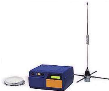
FIGURE 5.4 – Aquarius : capteur GPS temps réel à précision centimétrique
