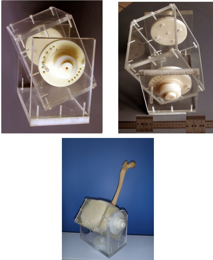
FIGURE 5.4: Guide d'acquisition en plexiglas pour les tests sur os secs
