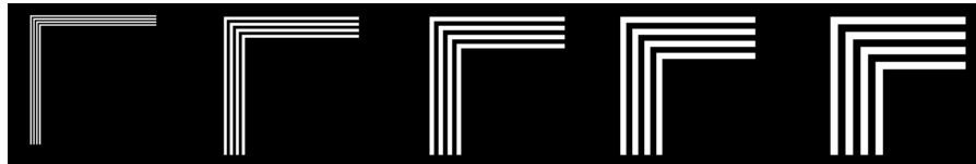
(a) Image affichée sur le modulateur Epson lors de l'insolation
