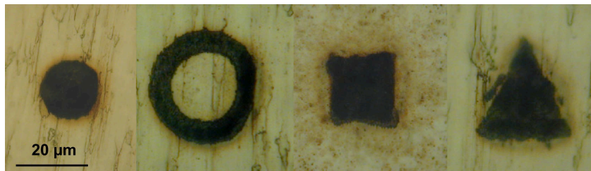
(b) Image du composant en acier inoxydable où Sanner a gravé avec 5 \times 10^5 impulsions de puissance 200 \text{ mJ}/\text{cm}^2 à \lambda = 800 nm
