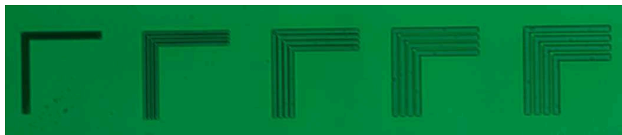
(b) Photo du composant prise à l'aide du microscope optique avec un grandissement 5x en affichant la figure 3.24a sur le SLM.
