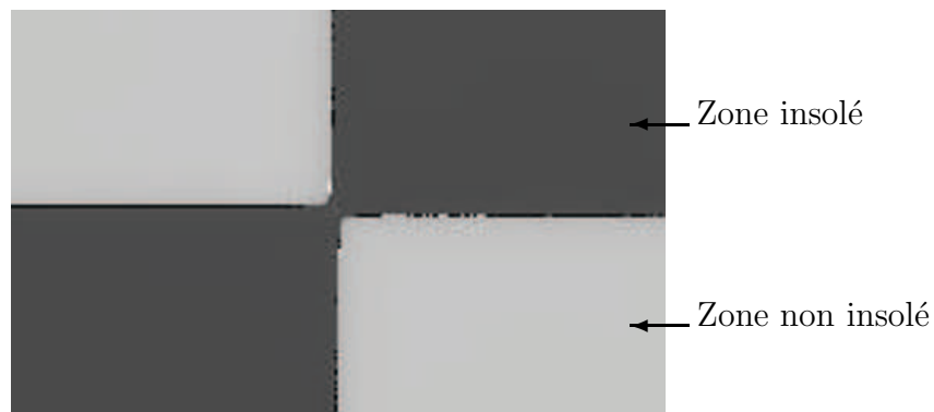
FIGURE 3.22 – Carte des profondeurs d'un composant fabriqué à l'aide du micro-écran Epson avec une surrésolution de 4 \times 4 . Les zones sombres sont les zones gravées et les zones claires sont les zones non-gravées.
