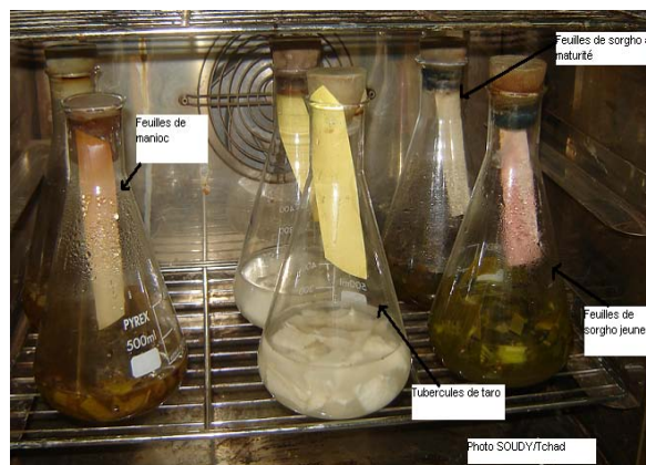
Figure 38 : Test de détection du cyanure dans les feuilles de manioc, dans les feuilles de sorgho et dans les tubercules de taro
