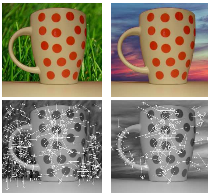
FIG. 1.viii – Utilisation du détecteur SIFT sur une même image de tasse avec deux fonds différents.
