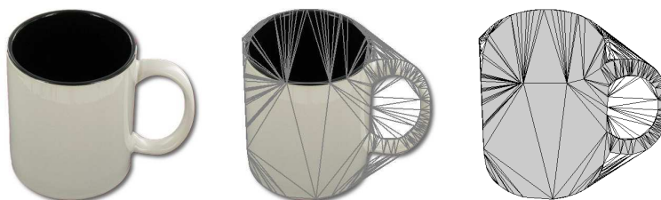
FIG. 5.ii – Le graphe correspondant au mug est à trous : les faces grises sont visibles, mais celles de l'intérieur de l'anse, en blanc, sont invisibles : on ne souhaite pas les prendre en compte pour la recherche du mug dans des images.
