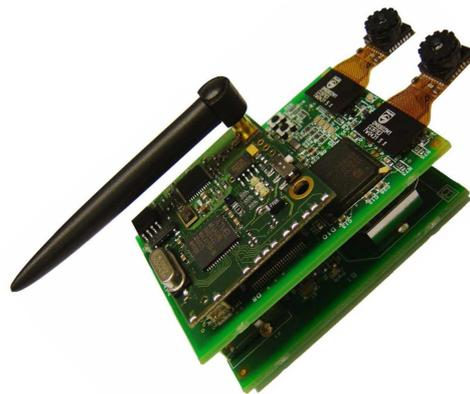
FIG. 3.8 – La caméra intelligente sans fil WiCa, de chez Philips Research Laboratories/NXP Semiconductors, Pays Bas.
