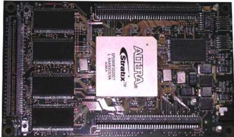
FIG. 3.21 – Photo de la carte contenant le composant FPGA ALTERA Stratix EP1S60. A gauche nous pouvons voir le connecteur de la carte sensorielle, et quatre des cinq blocs SRAM disponibles.
