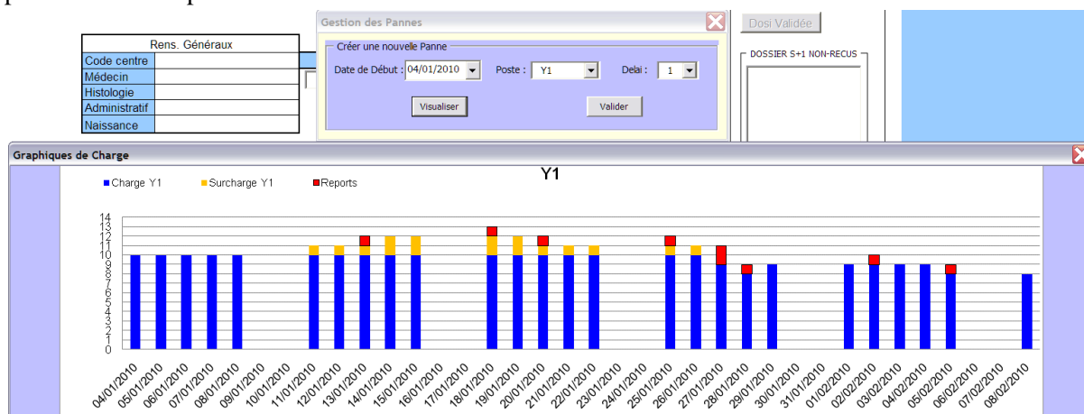
Figure 28. Interface de gestion des pannes et affichage des conséquences de la panne sur la charge planifiée pour la salle Y1.
