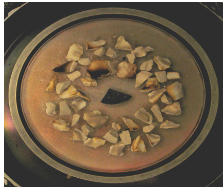
Figure III.C.7 : Photographie de la cible sur laquelle des pièces de codopants ont été disposés
