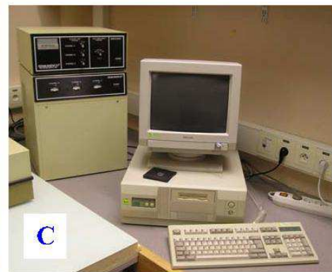
Figure 1 : Vue globale du spectrofluorimètre SLM 8000C Photo A : Module optique avec chambre de mesure, monochromateurs et détecteurs Photo B : Lampe au Xénon et son alimentation Photo C : Modules de commande et Pc
