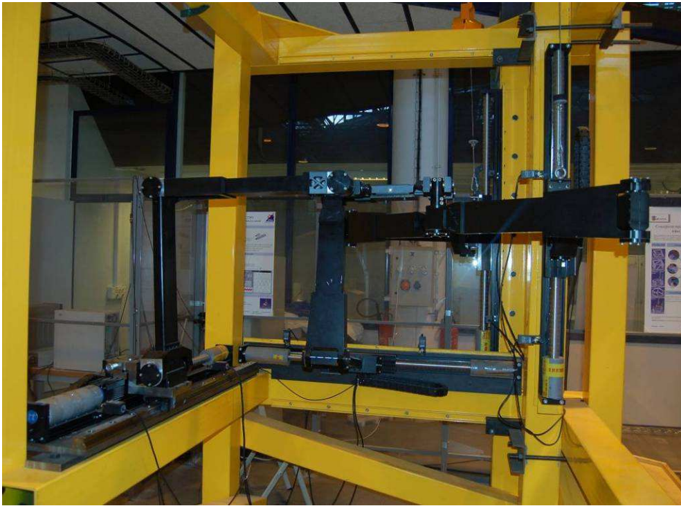
Figure 4-15 : Vue d'ensemble du prototype de l'Isoglide 4-T3R1
