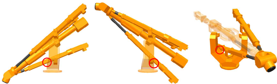
Figure 3.9 : Illustration des limitations des débattements angulaires des jambes
