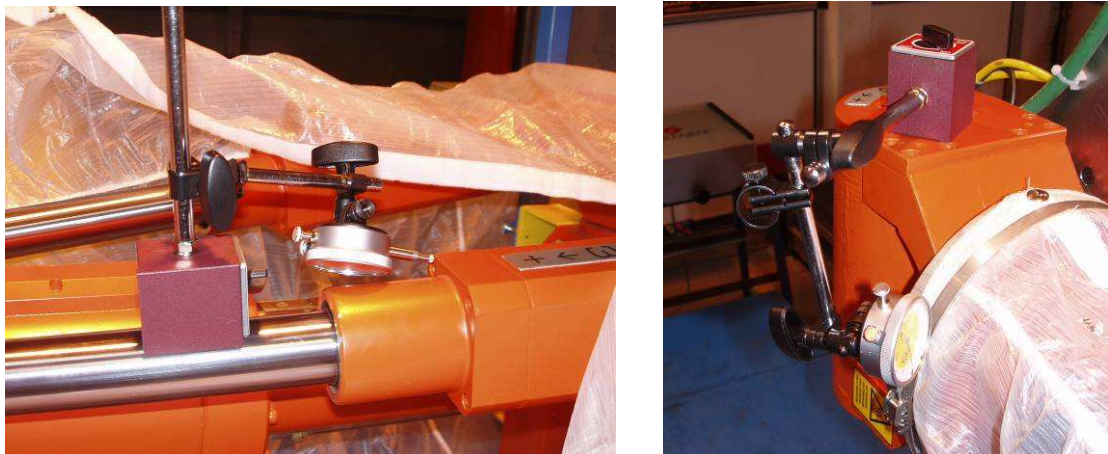
Figure H.1 : Mesure du jeu dans les liaisons, à gauche : jambe, à droite : poignet
