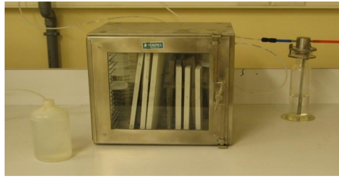
Figure 4.5 Montage expérimental de l'essai de carbonatation accélérée
