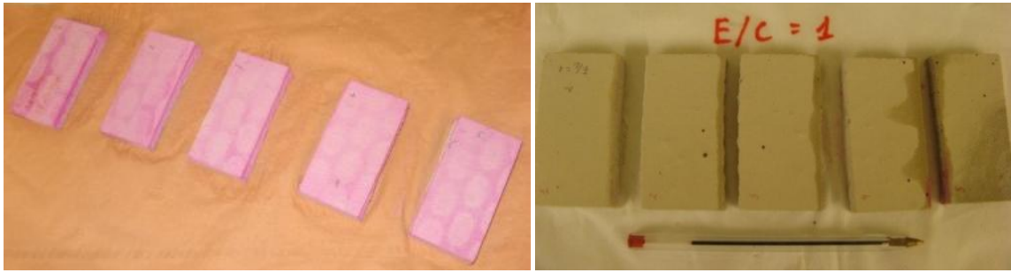
Figure 5.14 Aspect des éprouvettes de mortier de rapport E/C = 1 après pulvérisation d'une solution de phénolphtaléine, avant et après 36 jours de carbonatation
