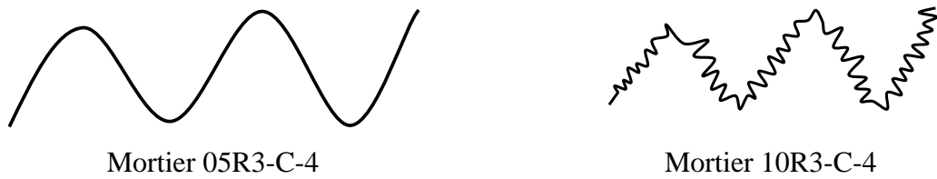
Figure 6.33 Schéma de la surface des mortiers de rugosité R3 étudiés dans l'essai n°4
