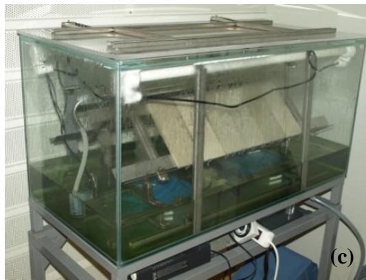
Figure 4.8 Dispositif d'étude de la colonisation accélérée par les algues des mortiers
