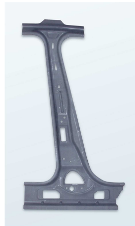
Figure 2.13: Pied milieu en Usibor (emboutissage à chaud)
