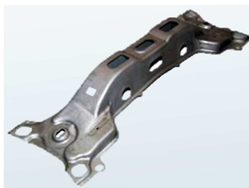
Figure 2.3: Traverse arrière en HSLA.
