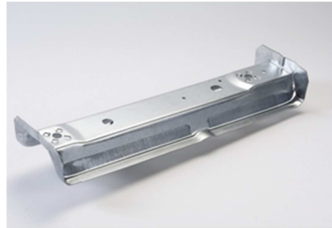
Figure 2.5: Traverse sous siège avant ou arrière en ferrite bainite.
