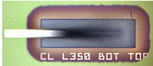
**Figure II-20 : photographie optique d'une poutre défléchie sous l'effet des contraintes dans le SiO<sub>2</sub>**
