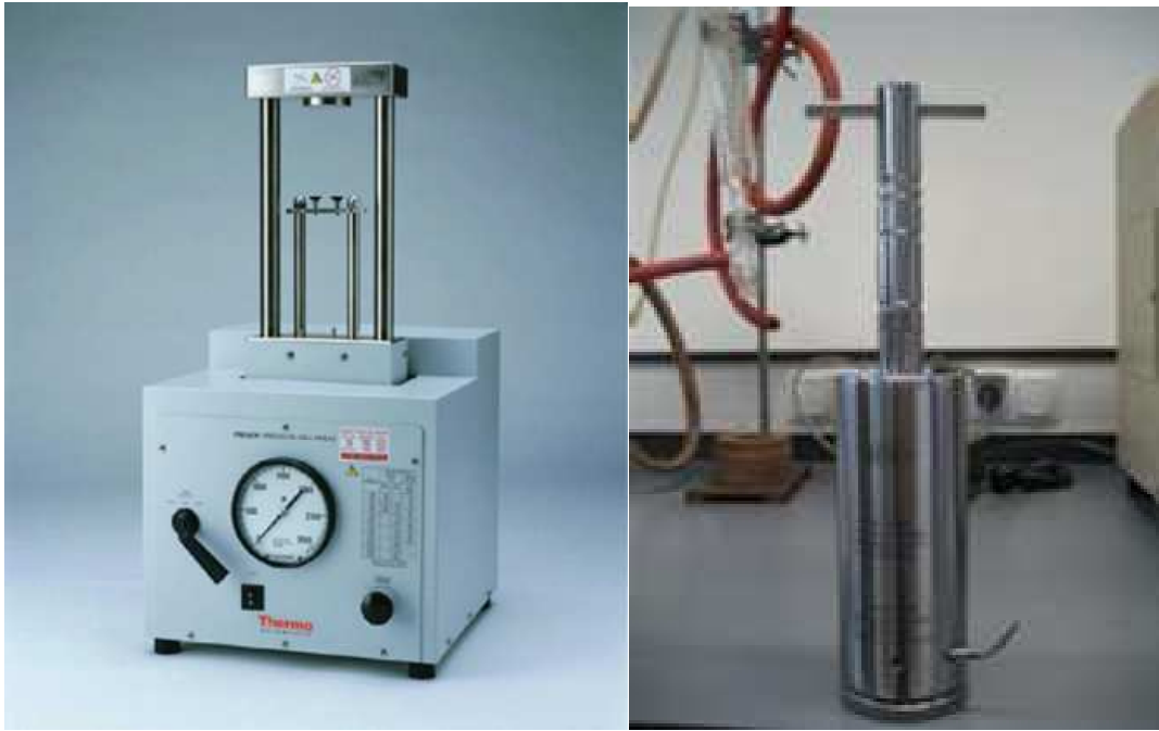
Figure II-5 : Presse de French et sa cellule de pression (Bioritech)
