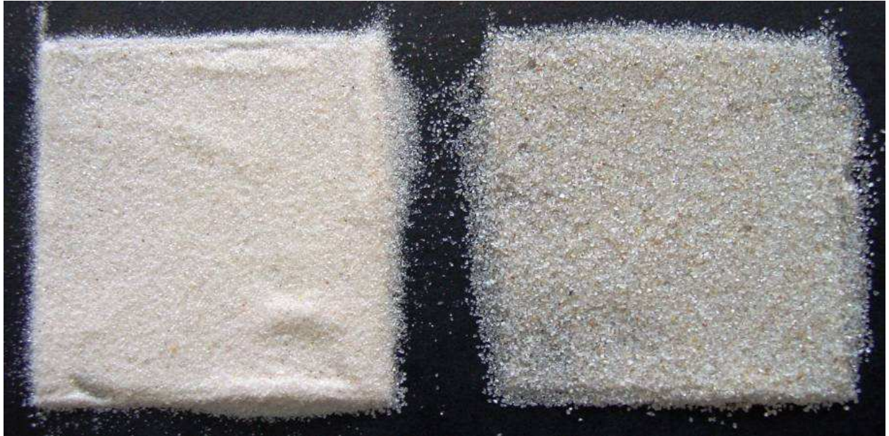
Figure IV-23: Photographie du sable de Fontainebleau (gauche) et du sable d'Hostun (droite).
