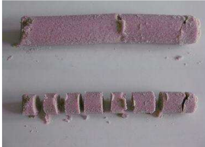
Figure V-1: Photographies montrant l'extraction et la découpe de colonnes de sable d'Hostun humide après les expériences transport de métaux ou de bactéries. Chaque tranche est ensuite récupérée intégralement et conservée en flacon à 4°C avant analyse.
