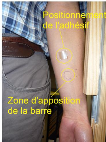
FIGURE 6.16 – Présentation de l'adhésif pour identifier le point de référence et de la zone d'application de la barre.
