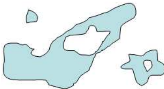
FIG. 2.18 – Paramètres topologiques : le nombre de trous est 2, le nombre de composantes connexes est 3, le nombre d’Euler-Poincaré vaut donc 1.
