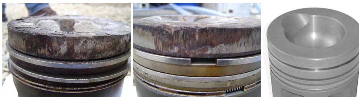
Figure 41 : Rayures sur les parois des pistons 1 (photo de gauche) et 2 (photo du milieu) correspondant aux prélèvements des échantillons D1 et D2 en comparaison à un piston neuf (photo de droite)
