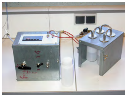
Figure 57 : Photographie du kit de prélèvement des COVSi par absorption dans un solvant
