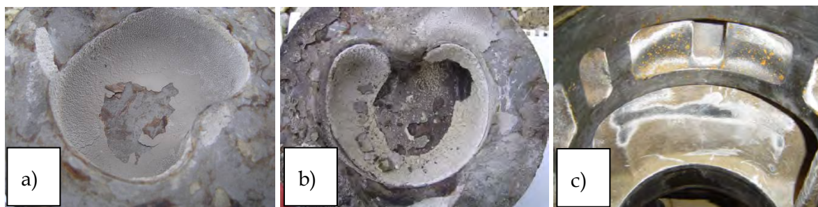
Figure 26 : Photographies avant prélèvement des dépôts du site D - a) D1 = Piston 1 - b) D2 = Piston 2 - c) D3 = Parois de la chambre de combustion
