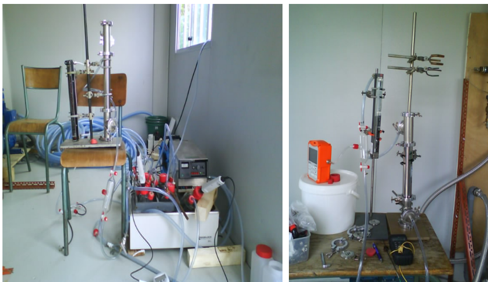
Figure 89 : Montage du pilote d'adsorption sur site
