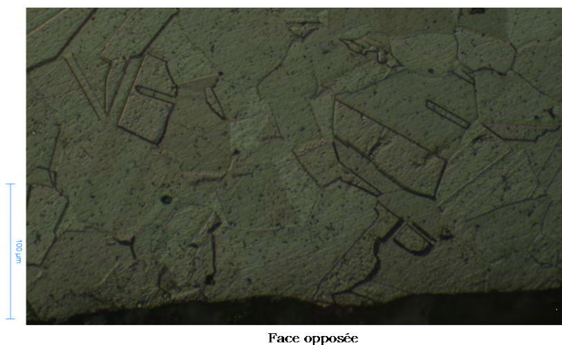
Figure II. 39 – Microstructure de la face opposée de l'éprouvette en acier 316L traitée à V_0 = 4 m/s et à T = 200\% , observée par microscope optique
