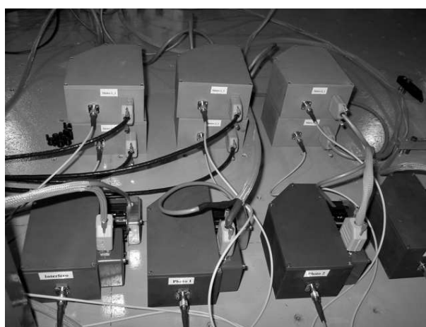
FIG. 5.20 – Photographie des modules de détection : six de métrologie en arrière plan, et quatre de science au premier plan.
