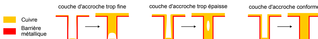
Figure 1.21 – Problématique du dépôt de la couche d'accroche de cuivre par PVD.
