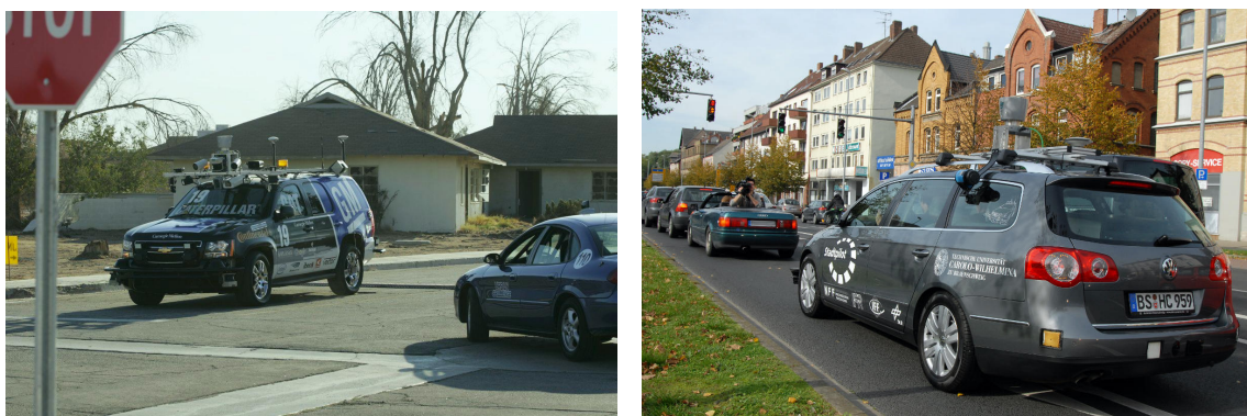
Figure 2.1: Véhicules autonomes. Boss , de l'équipe Tartan Racing de la Carnegie Mellon University (Darpa Urban Challenge) et Caroline de la Technische Universität Braunschweig (projet Stadtpilot).
