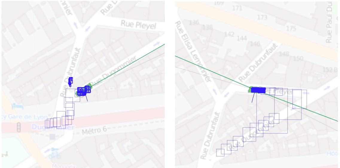
(a) Pose ambiguë au début de l'essai (solution non-connectée) (b) Pose non-ambiguë (ensemble solution connectée)
