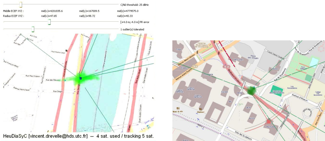
Figure 4.21: Visualisation 3D des zones de localisation calculées sur les Quais de Seine à Paris et à La Défense. À droite, une mesure aberrante a été identifiée et représentée en rouge.
