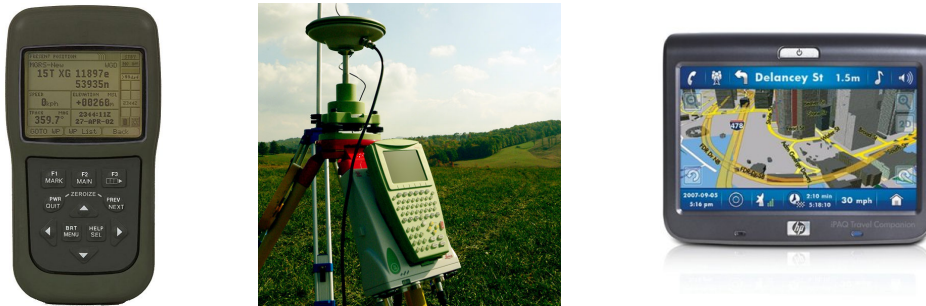
Figure 2.4: Récepteurs GPS militaire, géodésique et grand public
