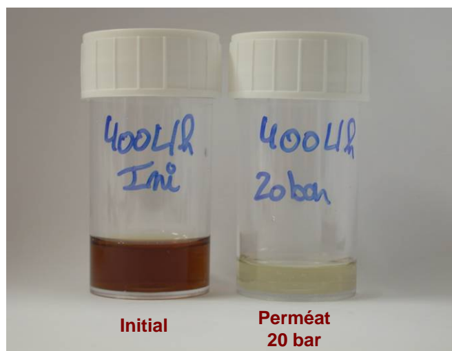
Fig. V-12 . Décoloration opérée par la nanofiltration d'un jus de fermentation brut clarifié - Jus n°3 - \Delta P = 20 bar
