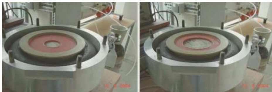
FIGURE 3.2 – Adaptation du perméamètre Cembureau à l'aide d'une masque en silicone ; diamètres de 50mm (gauche) et 110 mm (droite)
