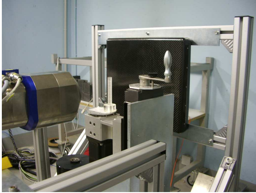
FIGURE 1.5 – Photographie de la plateforme CBCT : le tube à rayons X est visible à gauche, la platine de rotation au centre (sur laquelle est posée une mire de calibration) et le détecteur Pixium 2630S à droite.
