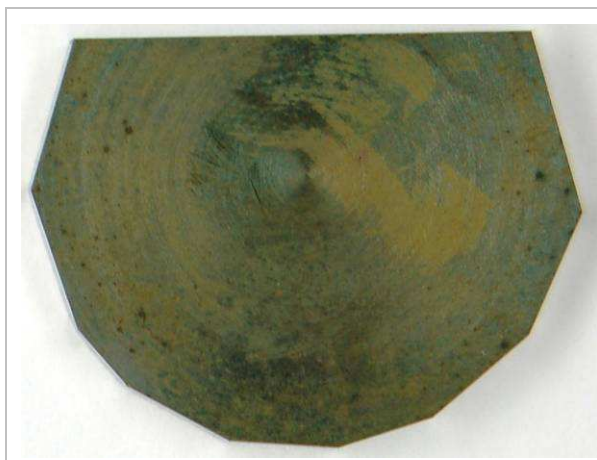
Figure III-27 : Photographie de l'oxyde formé sur un coupon plan brut d'usinage d'alliage 690 exposé 840 h en eau supercritique (600 °C – 250 bar) [tension d'accélération de 5 keV]
