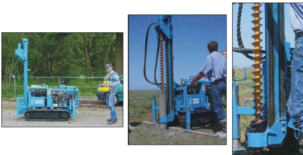
Figure IV-4 : Photographies illustrant la mise en place et l'utilisation de la sondeuse
