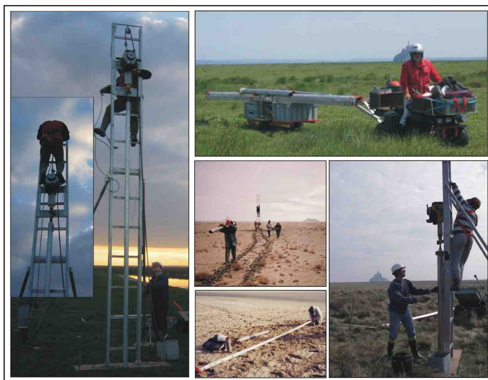
Figure IV-1 : Photographies illustrant la mise en place et l'utilisation du carottier terrestre.
