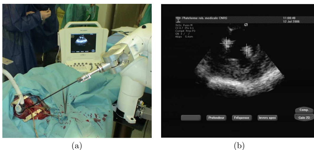
FIG. 2.15 – (a) Expérimentation in vivo réalisée sur cochon de l'approche d'asservissement visuel proposée par Vitrani et al. [Vitrani 2007]. (b) Détection automatique des deux points d'intersection de l'instrument avec le plan de la sonde, qui sont utilisés comme information visuelle.
