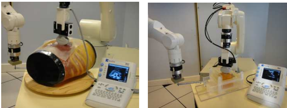
FIG. 5.12 – Dispositif expérimental impliquant un fantôme abdominal (à gauche) et un fantôme déformable en gélatine (à droite). La perturbation périodique est appliquée au fantôme à l'aide d'un second système robotique.
