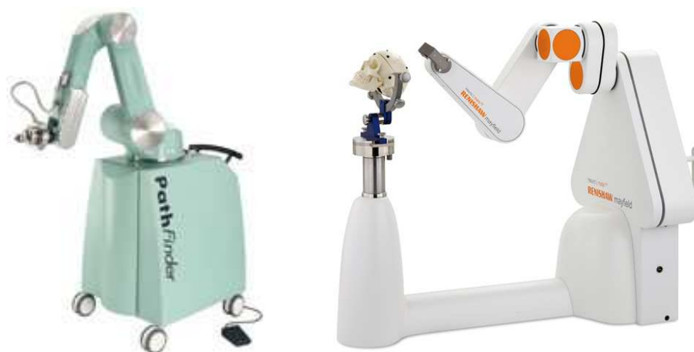
FIG. 1.6 – Des robots dédiés aux opérations de neurochirurgie. PathFinder [Deacon 2010] (à gauche) et Neuromate [Varma 2006] (à droite) assurent une insertion précise d'outils en neurochirurgie.
