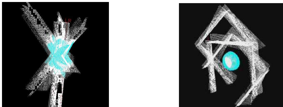
FIG. A.5 – Reconstruction de la sphère avec les paramètres de calibration estimés à partir de trois positions atteignables. A gauche, les 11 paramètres de calibration sont optimisés simultanément. A droite, les facteurs d'échelle sont estimés a priori puis les 9 paramètres de calibration sont ensuite optimisés
