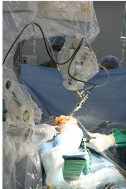
FIG. 1.5 – Le robot orthopédique ROBODOC [Taylor 1994] réalisant une opération de chirurgie du genou.
