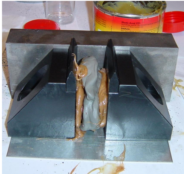
Figure 16 : Préparation des échantillons avant la compression. Le corps vertébral est entouré de pâte à modeler et les plateaux sont recouverts d'une résine.
