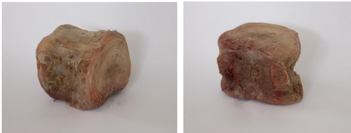
Figure 12 : Vue sous 2 angles différents d'une vertèbre L3 avant la tomographie ( \mu -CT) et les tests mécaniques.
