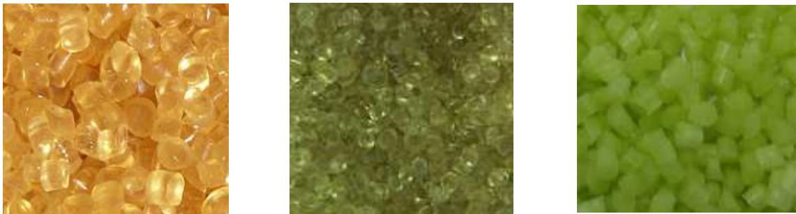
Figure II.10 : Granulés thermoplastiques obtenus après transformation du caséinate de sodium par extrusion bi-vis.
