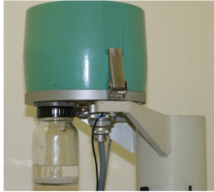
Figure III.14 : Thermobalance modifiée : précision 0.1mg, capacité 100mg.
