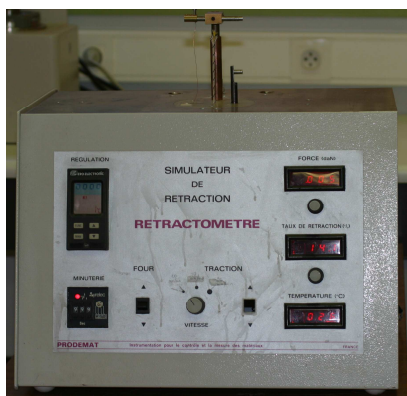
Figure IV.12 : Rétractomètre utilisé pour réaliser les essais mécaniques sur les films fins.
