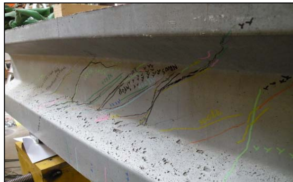
Figure 3-57 Fissures de ruine pour chaque poutre armée
