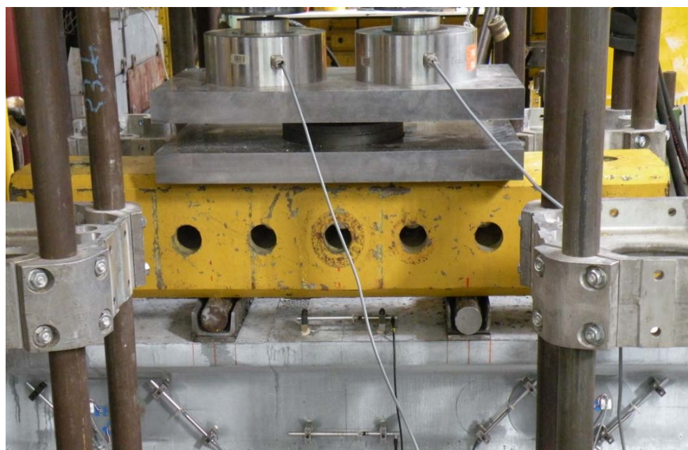
Figure 3-8 (a) Vue générale du montage côté Est (Poutre BFUB-B(2)-PC-WS) ; (b) Détail des points d'application de l'effort côté Est (Poutre BFUP-F-RC-NS)
