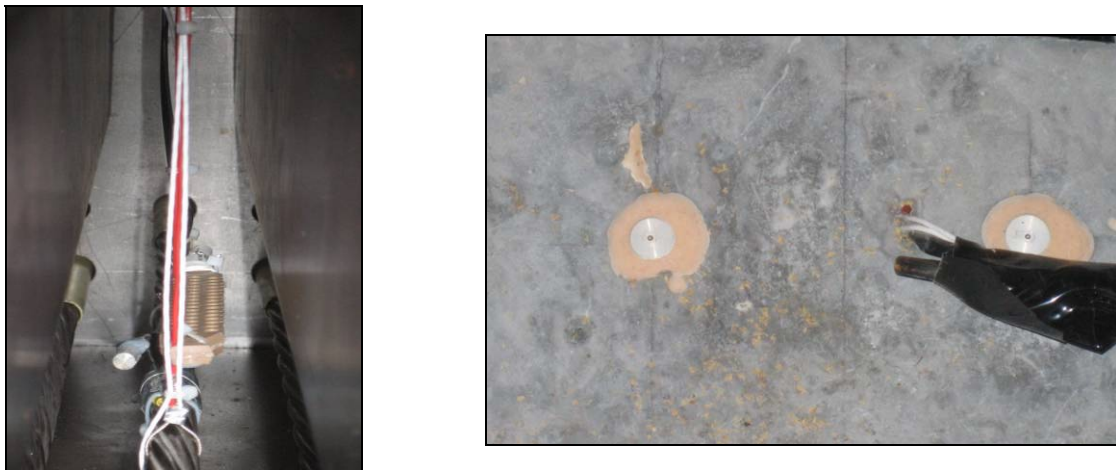
Figure 3-40 Instrumentation de la poutre BFUP-F-PC-NS afin d'estimer les pertes de précontrainte
