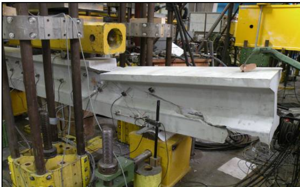
Figure 3-57 Fissures de ruine pour chaque poutre armée
