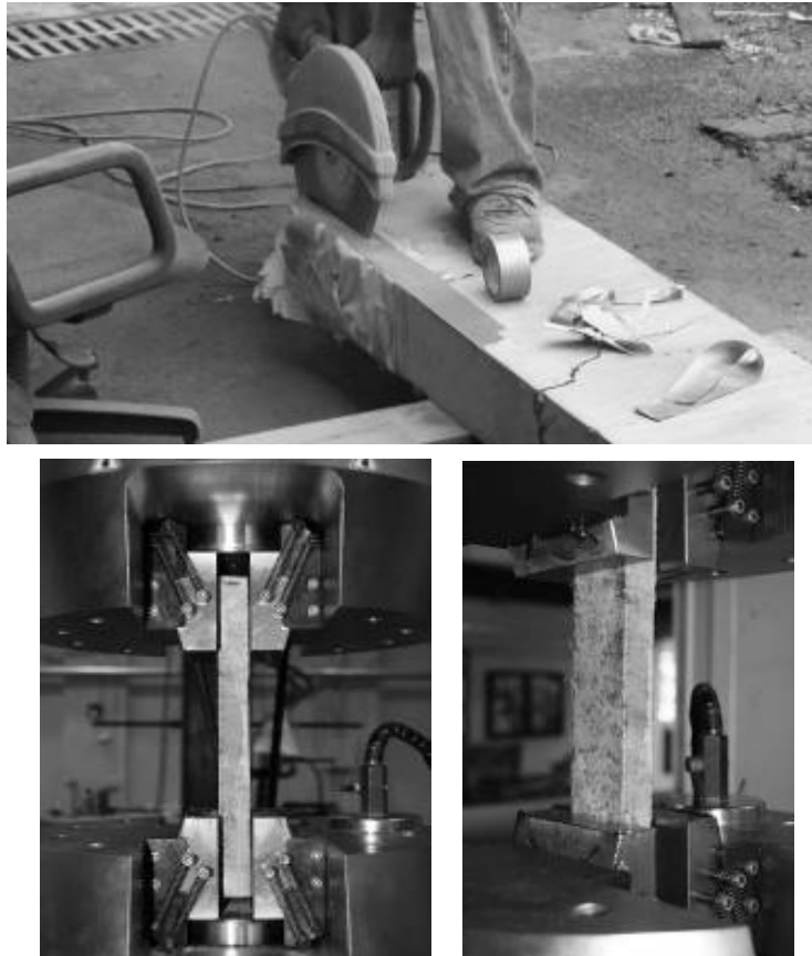
Figure 2-5 Essais de traction directe sur prismes sciés (Graybeal, 2010b)
