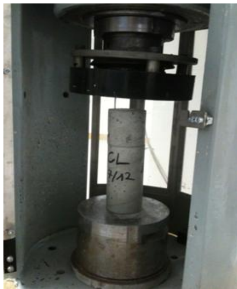
Figure 3.59. Banc d'essais de résistance en compression
