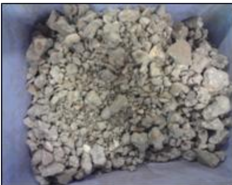
Figure 5.43. Eclatement des sphères \Phi 12 , BHP0
