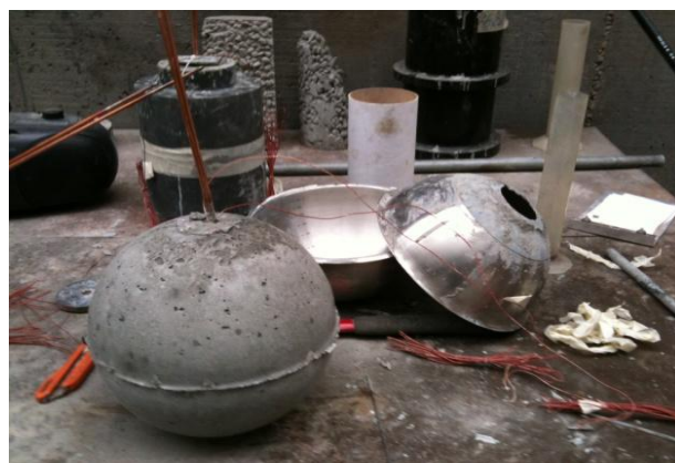
Figure 5.23. Sphère après le démoulage (diamètre 24 cm)
