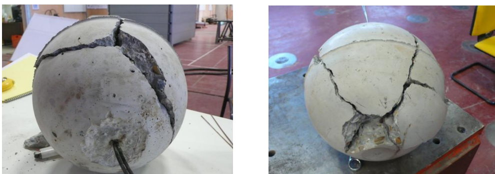
Figure 5.41. Eclatement des sphères \Phi 24 . BHP0
