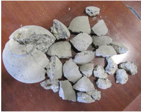
Figure 5.42. Eclatement des sphères \Phi 18 : à gauche, BHP1 et à droite, BHP0.
