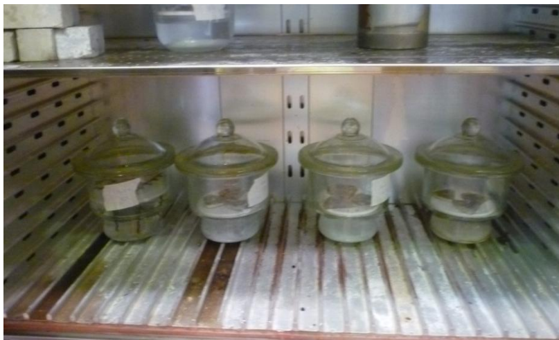
Figure 3.36. Installation des dessiccateurs dans l'étuve.
