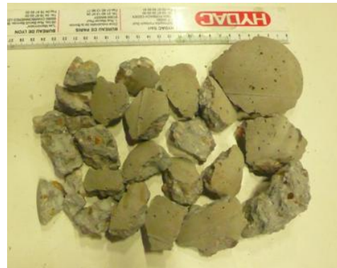
Figure 5.43. Eclatement des sphères \Phi 12 , BHP0
