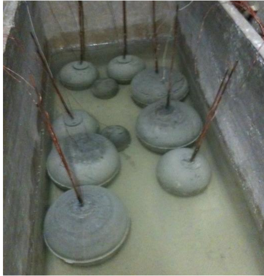
Figure 5.25. Conservation des sphères dans l'eau
