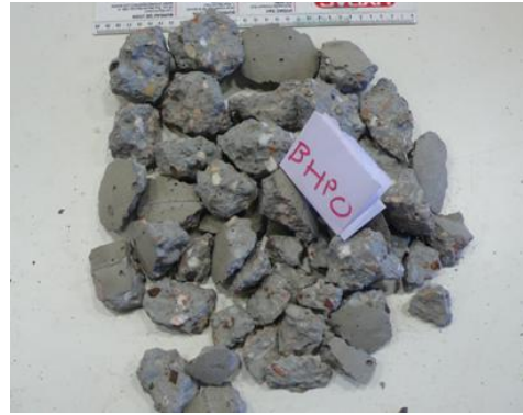
Figure 5.42. Eclatement des sphères \Phi 18 : à gauche, BHP1 et à droite, BHP0.
