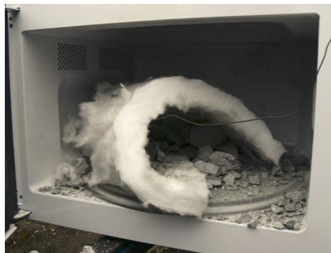
Figure 5.15. Exemple de l'éclatement d'un cylindre après exposition à des températures élevées [MIN 10].
