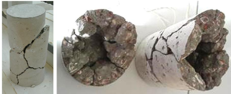
Figure 5.18. Exemple d'éclatement explosif d'un cylindre après le chauffage [KAN 07b]
