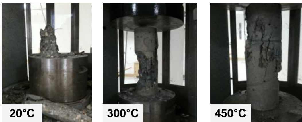
Figure 3.63. Mode de rupture des éprouvettes lors des essais de compression réalisés à 20 sur des bétons portés préalablement à 300°C et 450°C, pour les images de droite.
