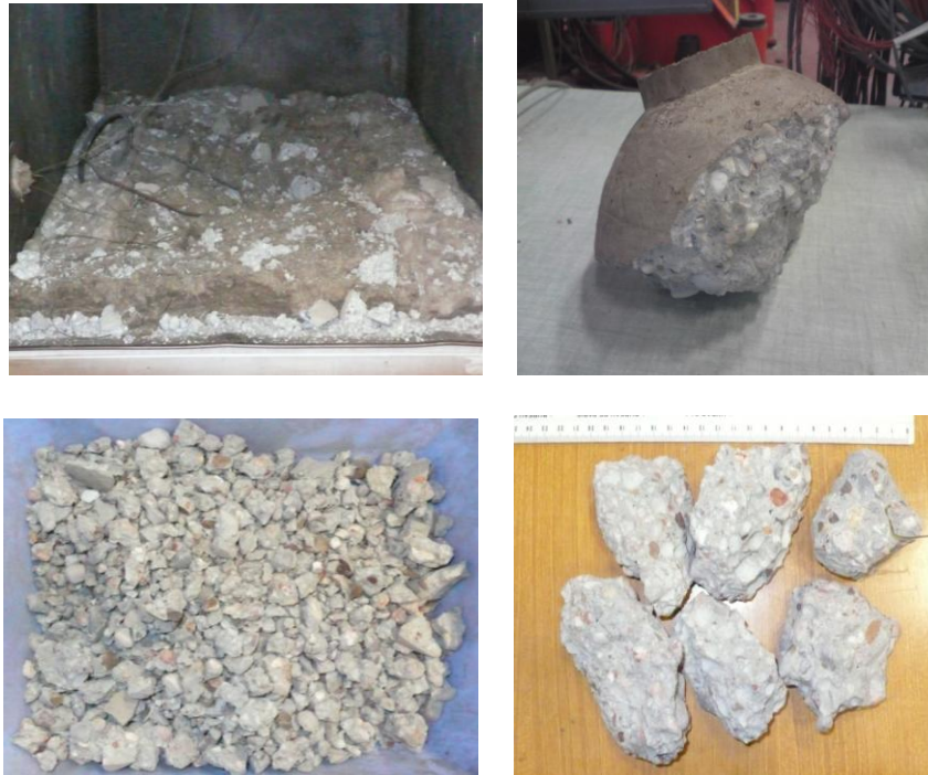
Figure 5.31. État de la sphère avant et après l'essai et la taille de différentes écailles.
