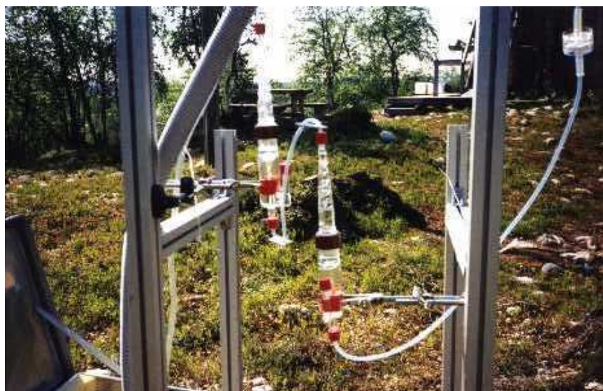
Figure IV- 1 : Schéma, principe de fonctionnement et photographie des chambres à brouillard. Le préfiltre est situé à droite sur la photo.
