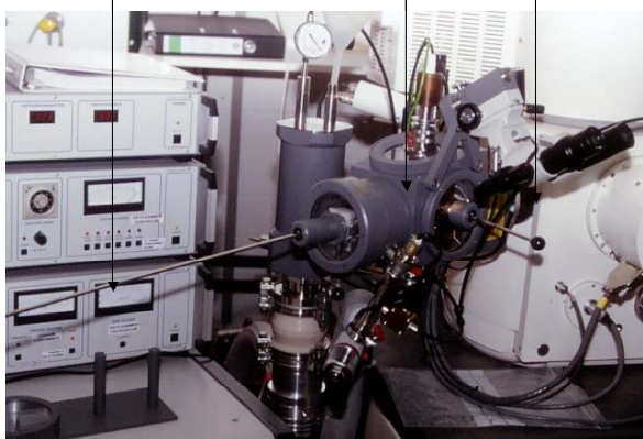
Figure II.30 : Tige du porte échantillon, chambre de transfert et chambre principale du microscope électronique à balayage à effet de champ LEO 1530 utilisé pour les observations à l'université de Göttingen.
