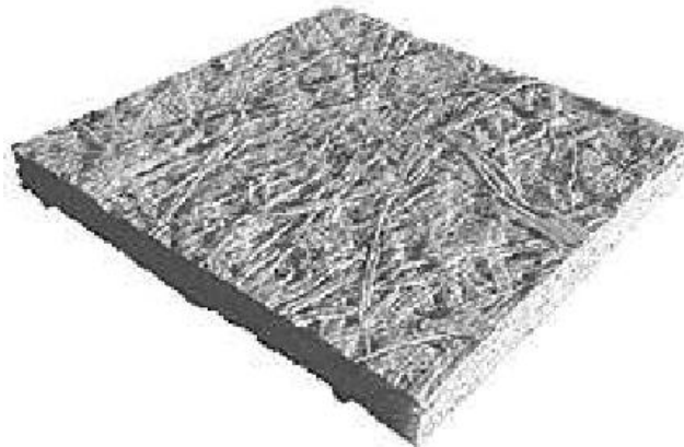
FIGURE 3.35 – Structure en 3D d'un papier par microtomographie aux rayons X (Photo de N. Reverdy-Bruas, EFPG)
