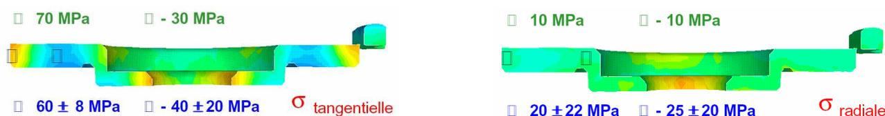
Figure 20. Etat de contraintes dans un disque plein, en fonte, suivant une coupe de plan vertical. Ligne du haut (en vert) : valeurs prédites par le calcul. Ligne du bas (en bleu) : valeurs mesurées.
