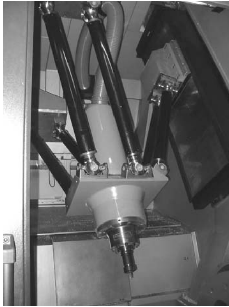
Figure 1-5 : Structure de type delta : la Verne de Fatronik (photo prise à l'IRCCyN, Nantes)
