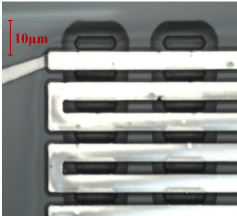
Figure 4.46 – Serpentin de NiFe électrodéposé sur structure isolante en SiO 2
