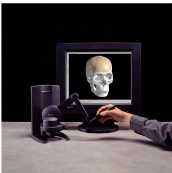
Figure 1.5 – Un exemple d'interface haptique : le Phantom de Sensable [10]
