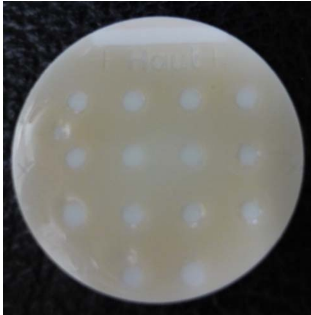
Figure 4.15: Résine SU8 non dopée insolée et révélée
