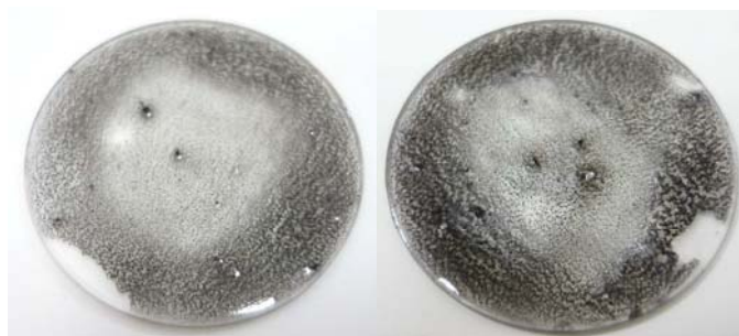
Figure 2.49 : Echantillons de matériau nanocomposite dopé à 1% sur des substrats de verre
