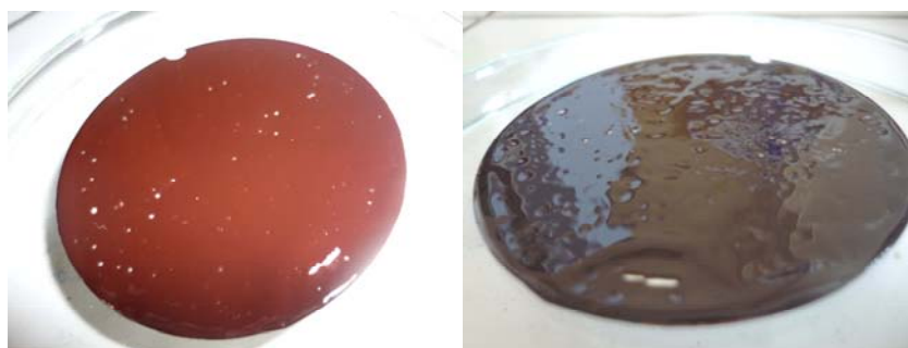
Figure 2.55 : Couches homogènes de nanocomposites avec des nanoparticules surfactées
