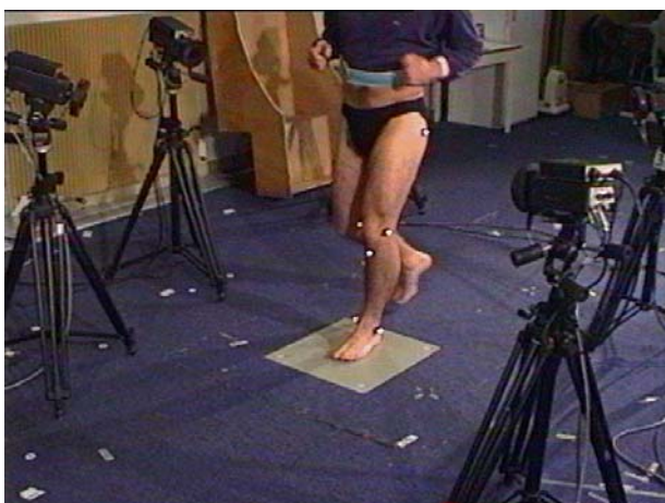
Figure 51 - Enregistrement d'un cycle de marche. On distingue les caméras Motion ainsi que la plateforme de forces.
