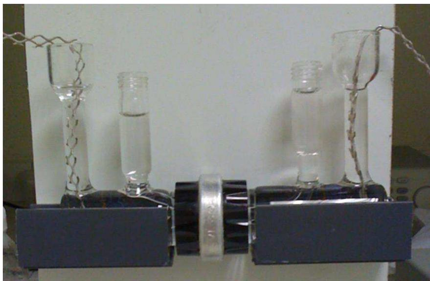
Figure 3 : Photo de la cellule de Hittorf.
