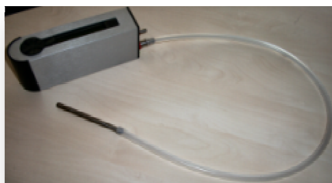
Figure III-1 : Photographie du système de prélèvement actif (pompe et tube Tenax)
