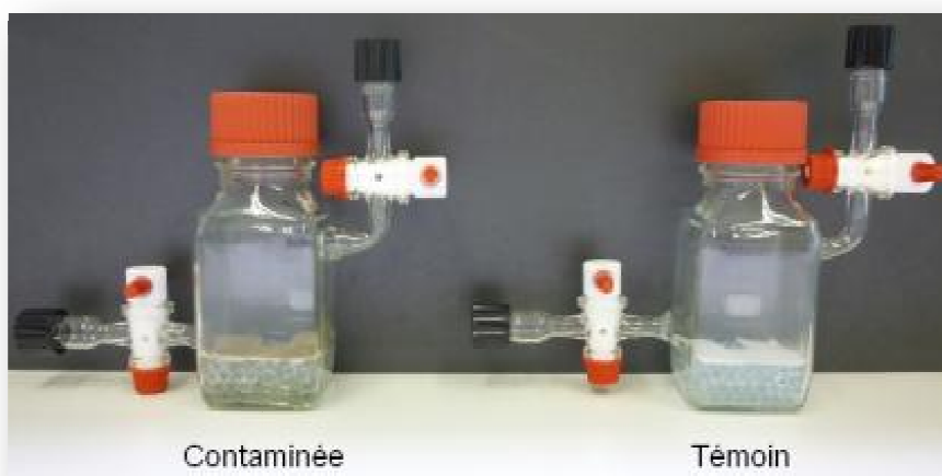
Figure II-4 : Photographie d'une chambre d'émission sur le support modèle (contaminée par P. brevicompactum et témoin).
