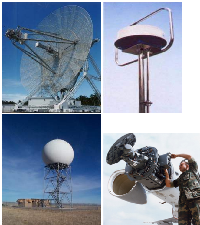
Illustration I.2 : Photographies de radars conventionnels, dans le sens de lecture : radar terrestre, radar maritime embarqué, radar météorologique, radar aérien embarqué
