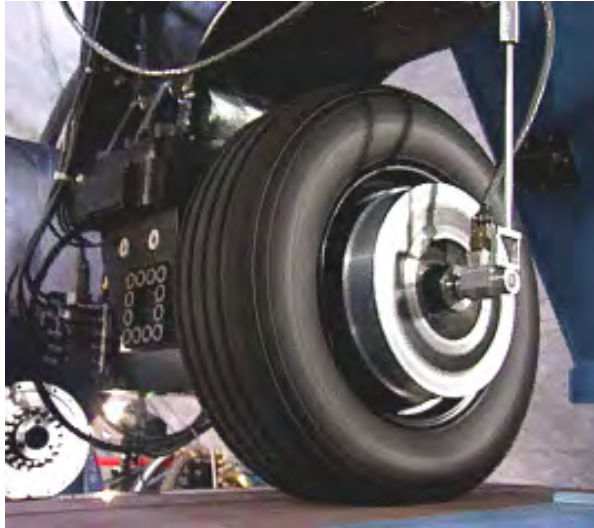
Figure 3-67 : Détail du banc de caractérisation des pneumatiques MTS
