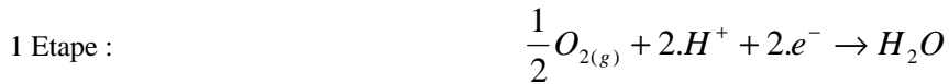
Fig. 11. Représentation schématique du mécanisme de réduction de l'oxygène à l'anode dans le cas d'un matériau conducteur mixte H^+ / électronique.
